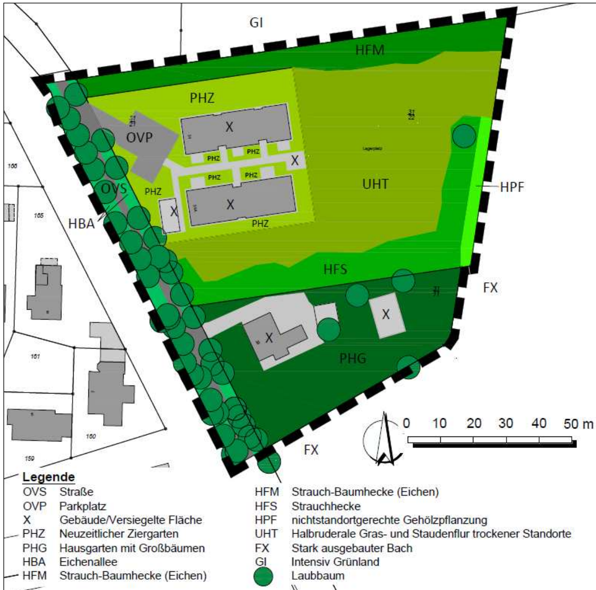
Abb. 2: Biototypen nach Drachenfels für den Bereich des Bebauungsplanes Nr. 191 (Erfassung August 2018), ohne Maßstab
